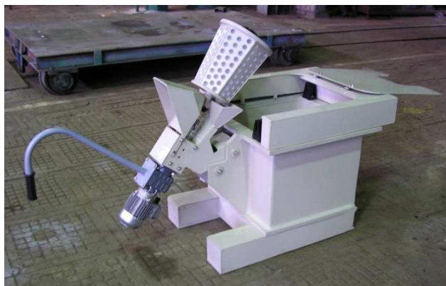
Рисунок 2.12 — Общий вид колокольной ванны погружного типа
